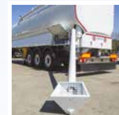
COCLEA AUTO-CARICO mt 4 CON MOTORE IDRAULICO
