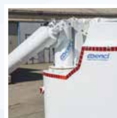
TERMINALE CURVA TUBO DI SCARICO DI TIPO TANGENZIALE CON MOTORE IDRAULICO
