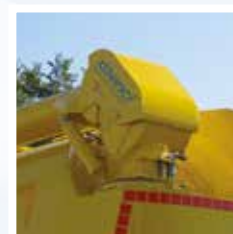
TERMINALE CURVA TUBO DI SCARICO DI TIPO MECCANICO CON CARDANICO ASSIALE "FAGIOLO"
